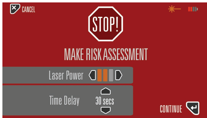
그림 2. 장비를 안전하게 사용하기 위해 Time Delay 또는 레이저 출력을 설정하는 화면이 제공됩니다.
